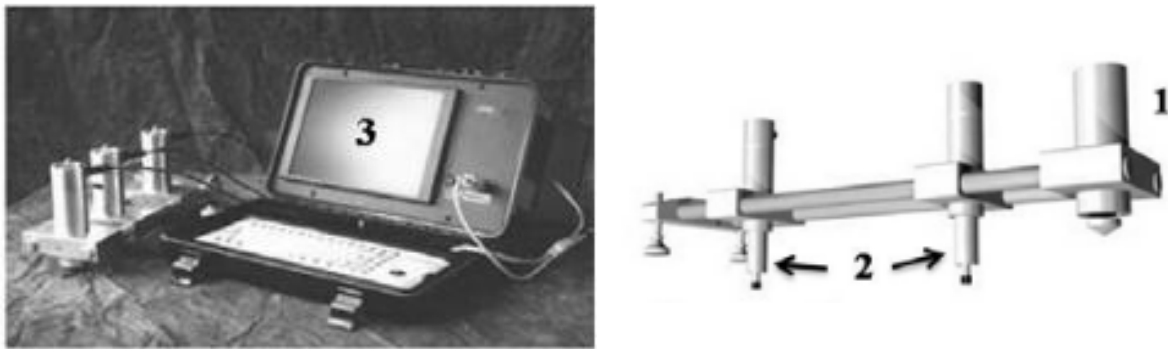
Рис. 1. Обладнання для реєстрації та обробки експериментальних даних: 1 – генератор імпульсного навантаження; 2 – сейсмоприймачі; 3 – комплекс з обробки сигналу
