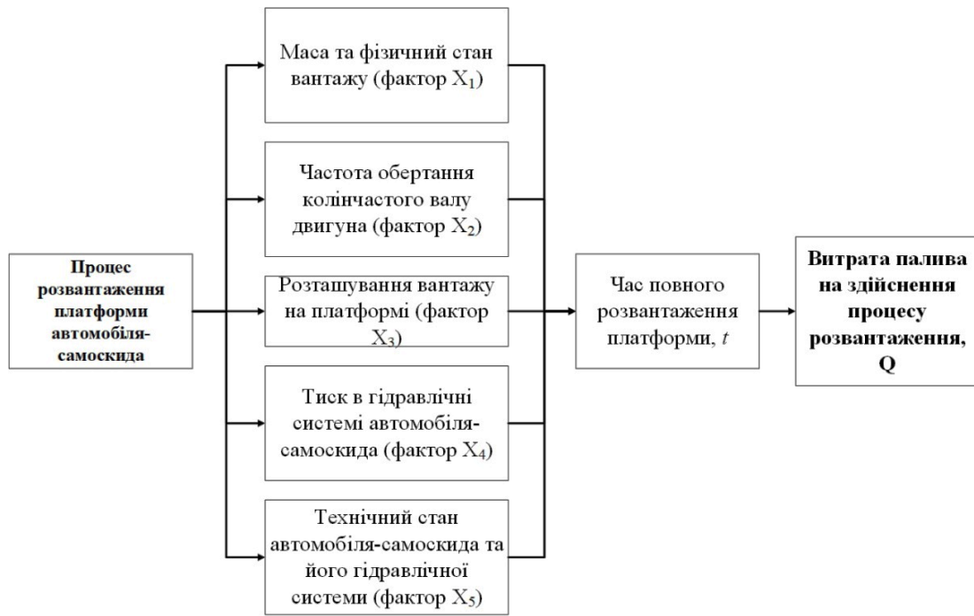
Рис. 2. Фактори, які безпосередньо впливають на показник витрати палива в процесі розвантаження платформи автомобіля-самоскида.
