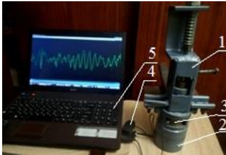
Рис. 2. Експериментально-вимірювальний комплекс 1 – ударна система; 2 – наковальня; 3 – датчик; 4 – блок підсилення та обробки сигналу; 5 – персональний комп'ютер
