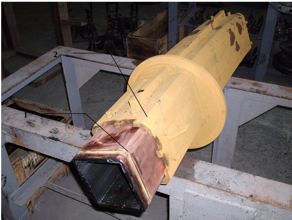
Рис. 2. Детали кристаллизатора (гильза с обечайкой в сборе) 1 – медная гильза; 2 – обечайка
