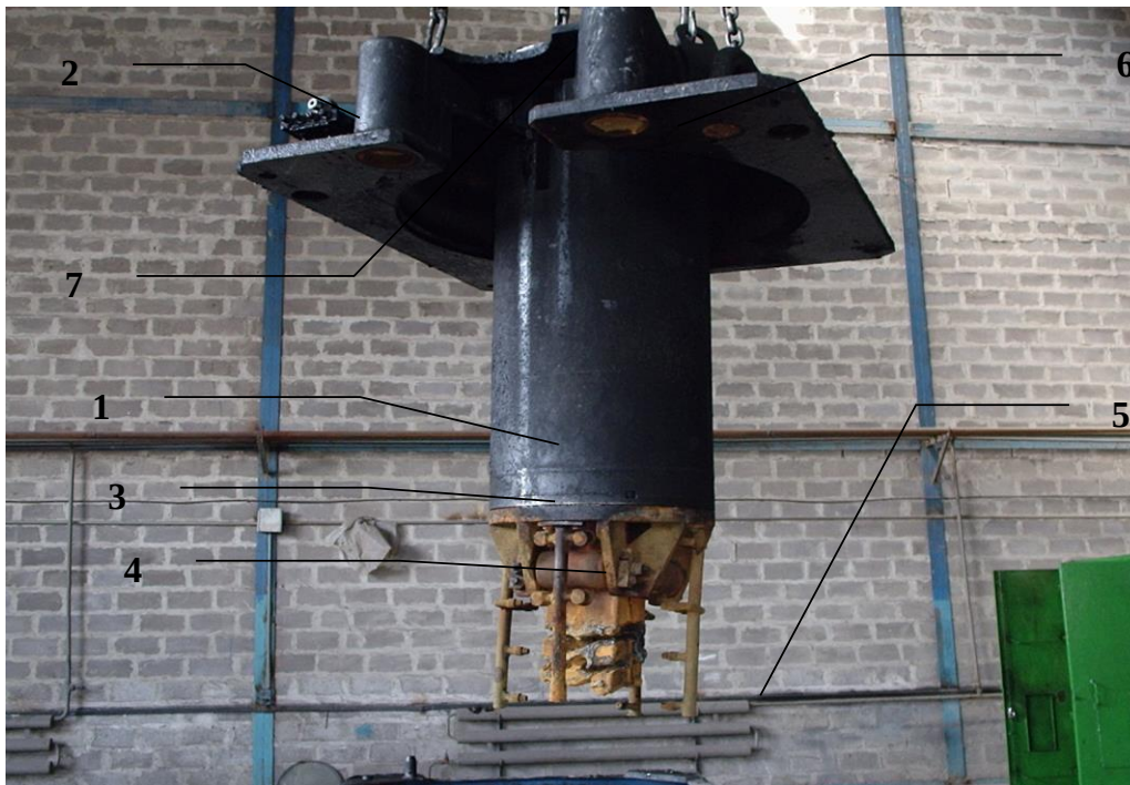
Рис. 1. Гильзовый кристаллизатор сортовой МНЛЗ ОАО «ЕМЗ» (в сборе) 1 – стальной кожух; 2 – дроссельное устройство, для распределения смазки (масло) по граням гильзы; 3, 7 – нижняя и верхняя крышка кристаллизатора с уплотнениями; 4 – поддерживающие ролики; 5 – коллектора 1-й секции ЗВО; 6 – подводящий воду патрубков
