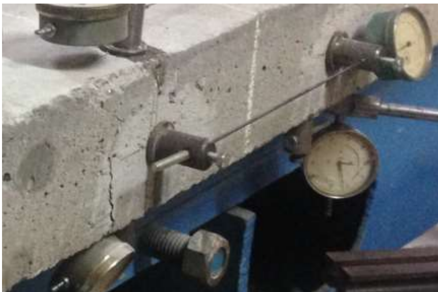
Рис. 2. Трещина, образовавшаяся в процессе испытаний плиты
