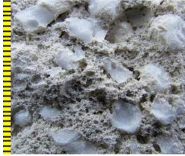
*Рис. 6. Структура ячеистого композита комплексной поризации*
