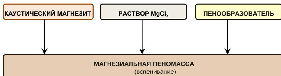
Рис. 3. Одностадийный способ приготовления магнизиальной пеномассы
