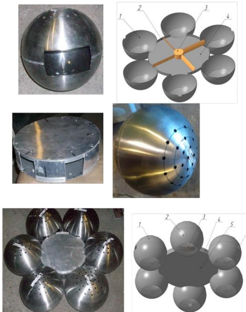
Рис. 1 – Многорезонаторная камера, 2 – нижняя перфорированная полусфера, 1 – верхняя полусфера, 3 – диссектор, 4, 5 – цилиндрическая часть резонаторной камеры, 6 – место для волновода
