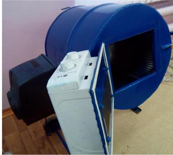
Рис. 1 - СВЧ установка для массажирувания и термообработки мясного сыра
