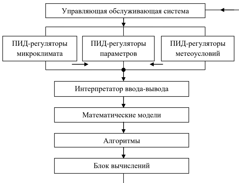
Рис. 1. Укрупненная схема управления электроэнергетическими установками
