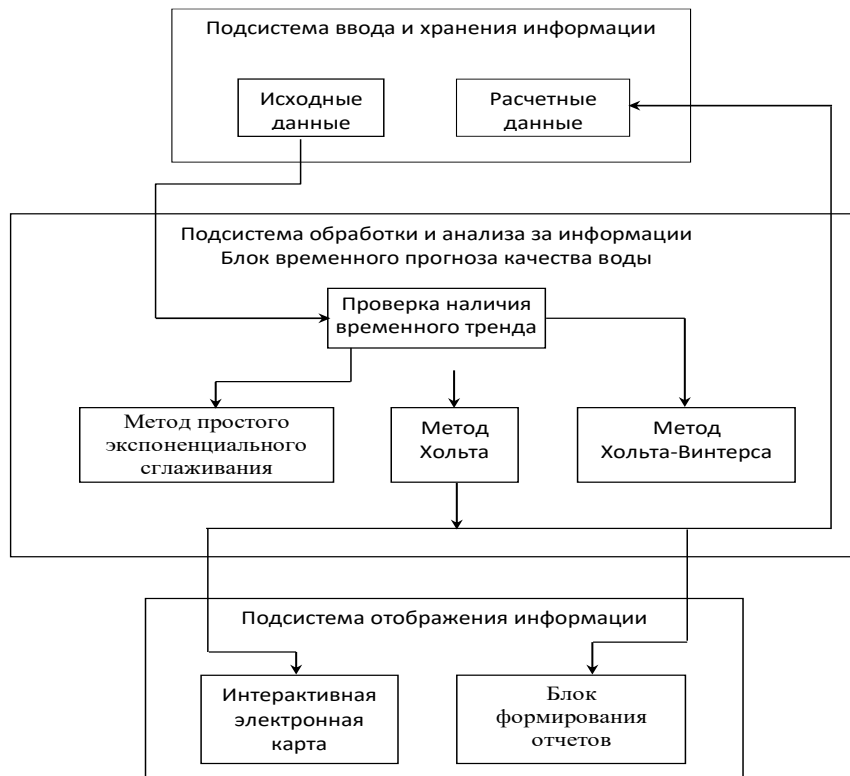
Рис. 2. Общая схема алгоритма прогнозирования значений показателей качества речных вод на определенный период времени
