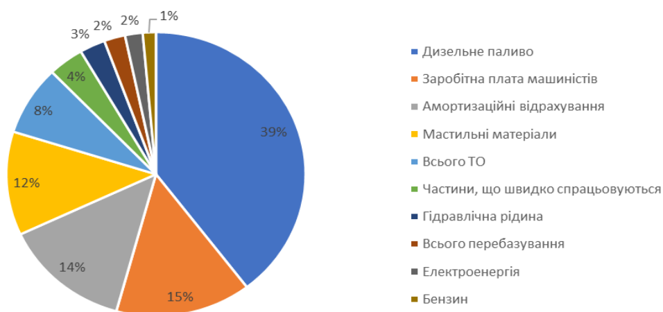
Рис. 6. Структура усередненої вартості 1 маш. год експлуатації машин і механізмів Джерело: побудовано автором на підставі Усереднених показників вартості експлуатації дорожніх машин та механізмів [6]
