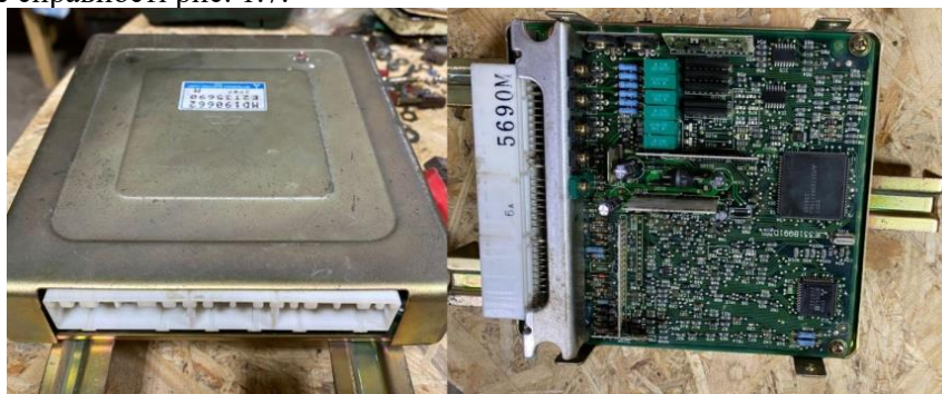
Рис. 1.7. Блок управління двигуном MD190662 від зверху, і від мікропроцесорної частини
